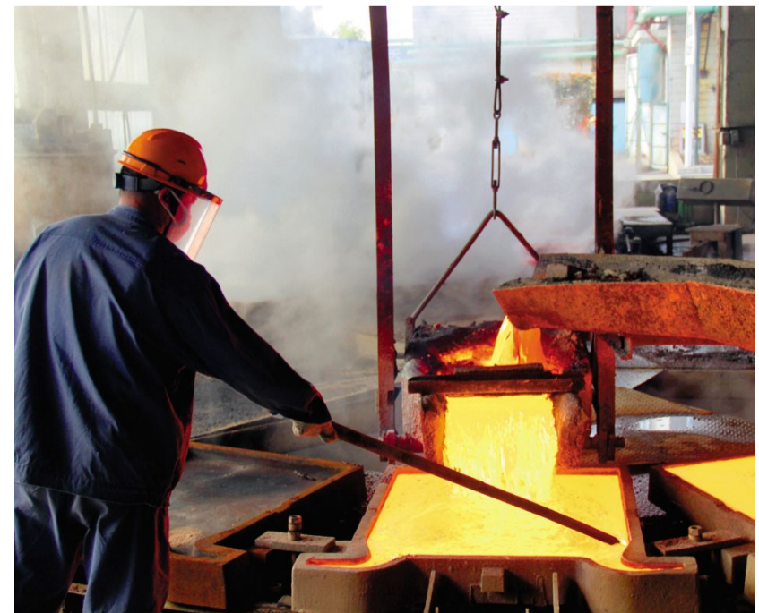
10月23日,张家港联合铜业公司一名员工正在进行阳极铜浇铸作业。进入10月份以来,该公司以“大干一百天、喜庆十九大”为主题,大力开展劳动竞赛,不断优化工艺技术和经济技术指标。其中,1号220吨固定式铜精炼炉连续生产136炉次,累计产铜30562.59吨,单炉产量达224.765吨,不仅创该公司1996年建厂以来最好水平,在同行业也处于领先水平。
