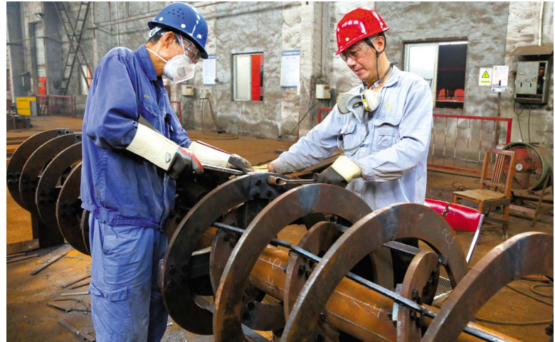
铜冠机械公司矿冶制造分厂职工日前正在制作搅拌机主轴。9月份,该分厂承接了新疆客户大修项目中双轴搅拌机等一批配件加工业务,目前制作已进入尾声。
