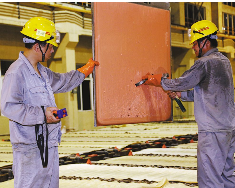
金冠铜业分公司电解车间职工正在认真检查处理槽内短路。为科学有效地把牢生产质量关,提升电铜产量,该公司在电铜生产过程中,以平衡电解东、西系统为基础,全过程关注电铜质量控制。通过严细管理,精心操作,使电解东、西系统的电解液杂质成分、铜酸浓度、体积等各项指标均趋于一致,为后期的生产控制创造了良好的控制环境。 封保敏 摄
