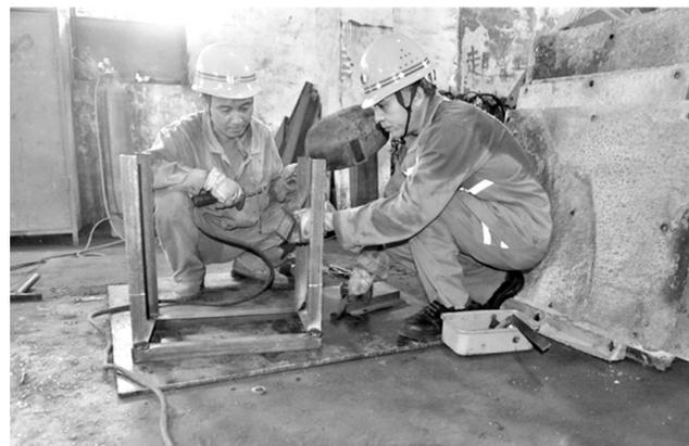
虽已立秋，但连日来的高温天气，还是给在厂内部进行维修作业的维修人员带来不小的困难。凤凰山矿业公司机运车间维修工段合理安排时间，利用矿内开车，设备维修保养的空档期，组织人员制作首绳的绳盘架子，为月底更换副井1.8米首绳的更换提前做好准备。 黄志皓 摄
