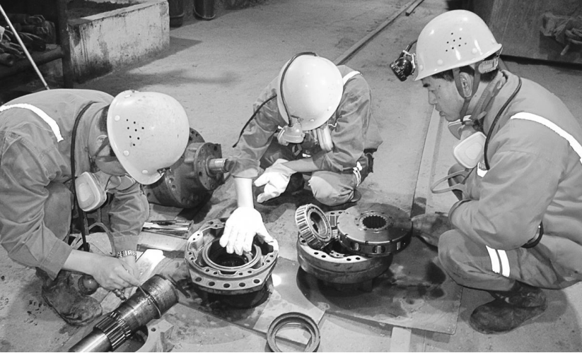
冬瓜山铜矿大团山工区针对井下生产使用的有轨与无轨设备较多,尤其是铲运机、运输卡车、电机车和T-150凿岩机等主要机械设备,加强设备维护与保养管理,将平时点检、保养与关键维修、维护相结合,注重规范化操作与维修提高质量相结合,确保设备处于良好状态,为安全生产服务。图为维修人员对T-150凿岩机液压泵传动轴进行维修。
