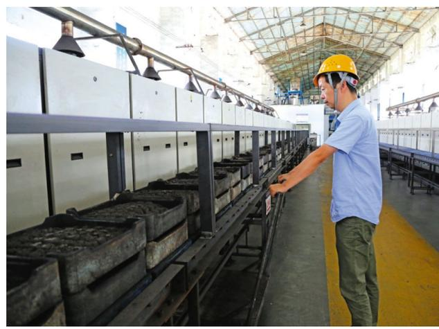
8月16日，金泰电池材料公司职工正在三元材料烧结合成中作业。金泰电池材料公司自去年实施了镍钴锰三元材料产业化建设，今年通过进一步技术改造与提升，使镍钴锰三元材料生产实现了规模化生产，改变了过去只能生产钴酸锂单一电池材料产品的局面。目前，该公司生产的镍钴锰三元材料已占到了电材料产能的一半。
