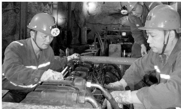
8月11日上午,铜山矿业公司采矿区维修工正在负568中段对5号铲运机发动机进行大修。该区树立过紧日子的思想,努力从降本增效上下功夫,大力开展修旧利废和技术攻关等活动,提高矿设备的完好率与利用率,提升生产效率。
