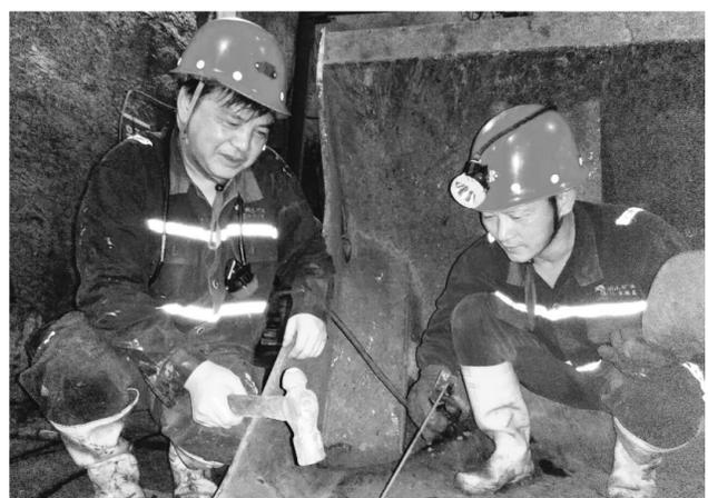
7月26日,铜山矿业公司采矿业维修工在负568中段对铲运机铲斗裂缝采取加钢板补焊措施。该公司采矿业自我加压降成本,针对铲运机铲斗磨损大,设计用耐磨钢板加焊底板,自制铲刃与报废铲斗拼接,既提高了生产效率又延长铲斗的使用寿命,修复一个铲斗可节约成本2万余元。
