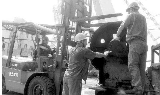
7月12日高温天气,安庆铜矿维修人员正在将转向轮吊运到井口,准备实施更换维修。据了解,目前已进入高温季节,该矿在搞好防暑降温工作的同时,加强设备的点检和维护,确保生产正常进行。 杨勤华 摄
