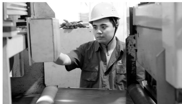
金威铜业公司板带分厂职工日前正在650薄剪机组巡查激光测试运行情况。金威铜业公司板带分厂650薄剪机组有两台激光测试仪,是从德国公司引进的,因激光测试仪的灯泡使用寿命在60天左右,价格昂贵,每年要用12只且现在基本停产,为满足生产需要,该公司技术人员通过反复摸索试验,成功地进行了改造,改造后使用国产灯泡每只使用寿命在120天左右,且价格每只仅20元,取得了很好的效果。
