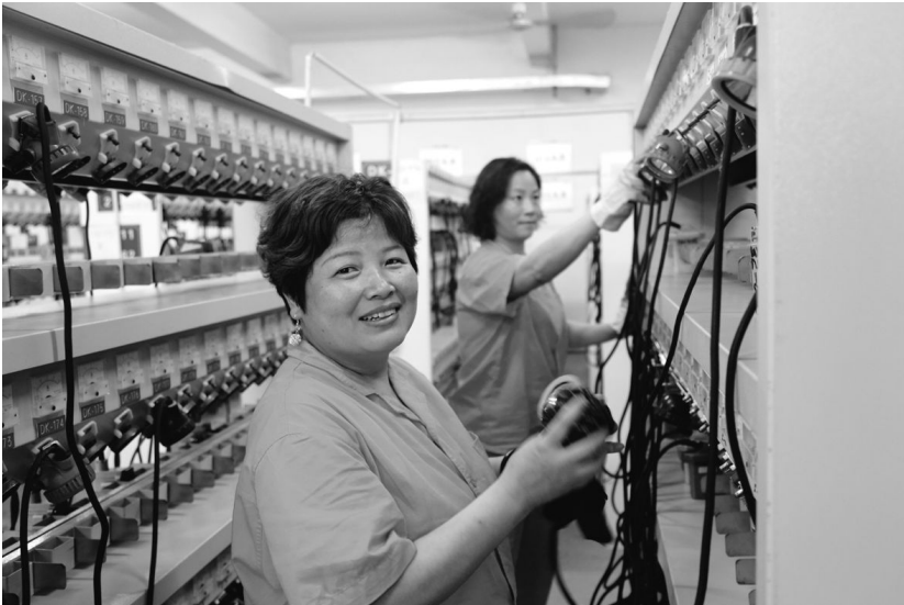
“矿灯就是矿工的‘眼睛’,我们要加倍地爱惜它,把它擦亮。”6月14日上午,镀灯房的充电工宋桂珍笑着说(如图)。担负着冬瓜山铜矿下井作业人员1400盏盖矿灯的收发、充电和保养等工作的动力车间运转女工班,她们用真心、精心、细心和关心坚守岗位,三班制作业巡检每一盏矿灯,认真做好擦洗、对号、充电、发放等工作,用心擦亮矿工们的“眼睛”,以关爱筑牢安全防线。杨李军 摄
