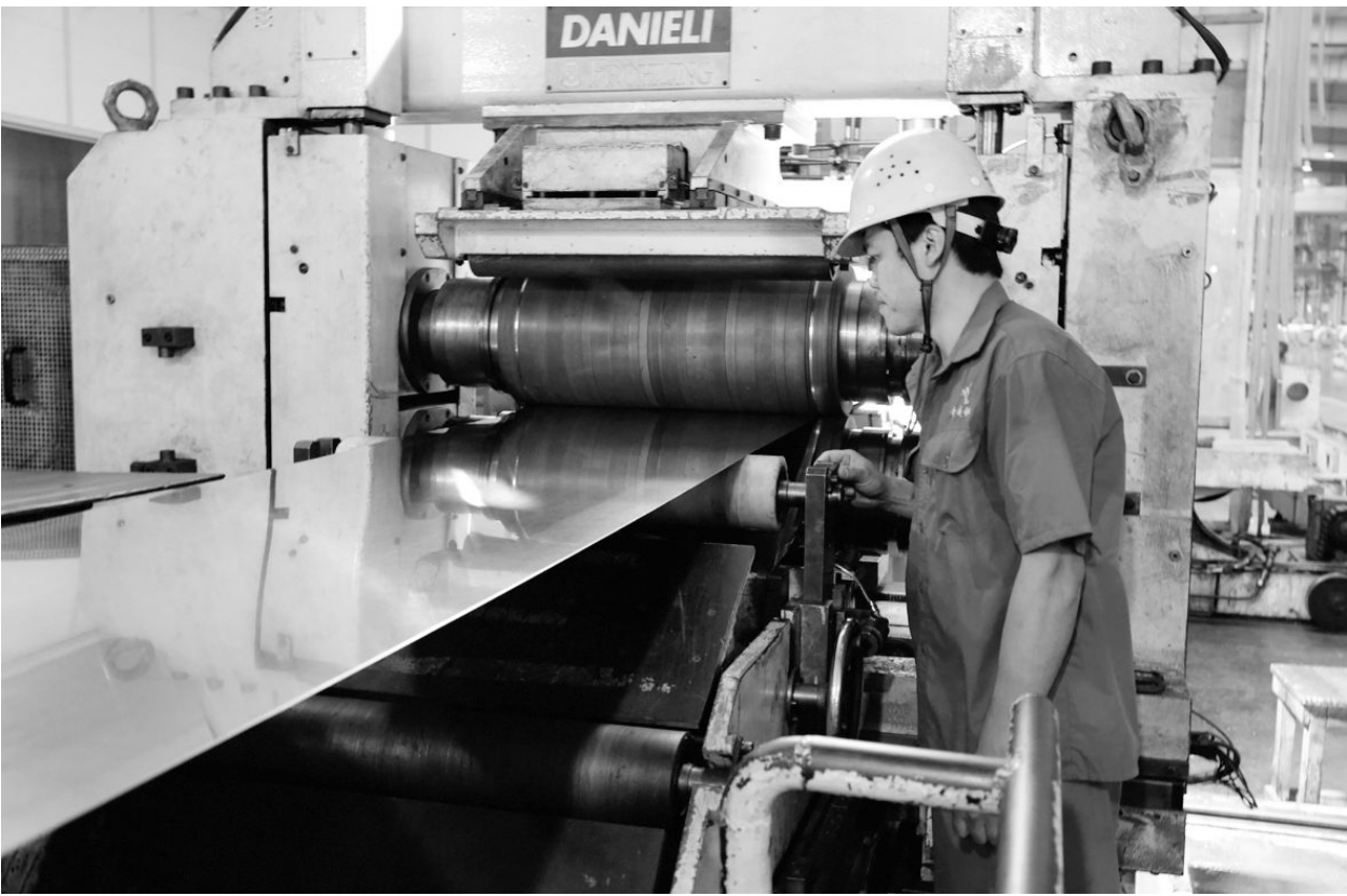
金威铜业公司职工日前正在查看650厚剪圆盘剪运转情况。金威铜业公司650厚剪整个机组设备来自多个厂家，由于设备匹配度不理想，生产中圆盘剪机架刀轴的公键与机架的母槽经常发生错位，导致刀头机械打不开，严重影响生产的连续性和设备精度。该公司技术人员从电气控制角度，采取对刀头和机组建立双PLC的电气连锁控制改造，成功解决了技术难题，使设备产能和生产的连续性得到了明显提升。这项改进被集团公司授予2016年度技术改造成果三等奖。
