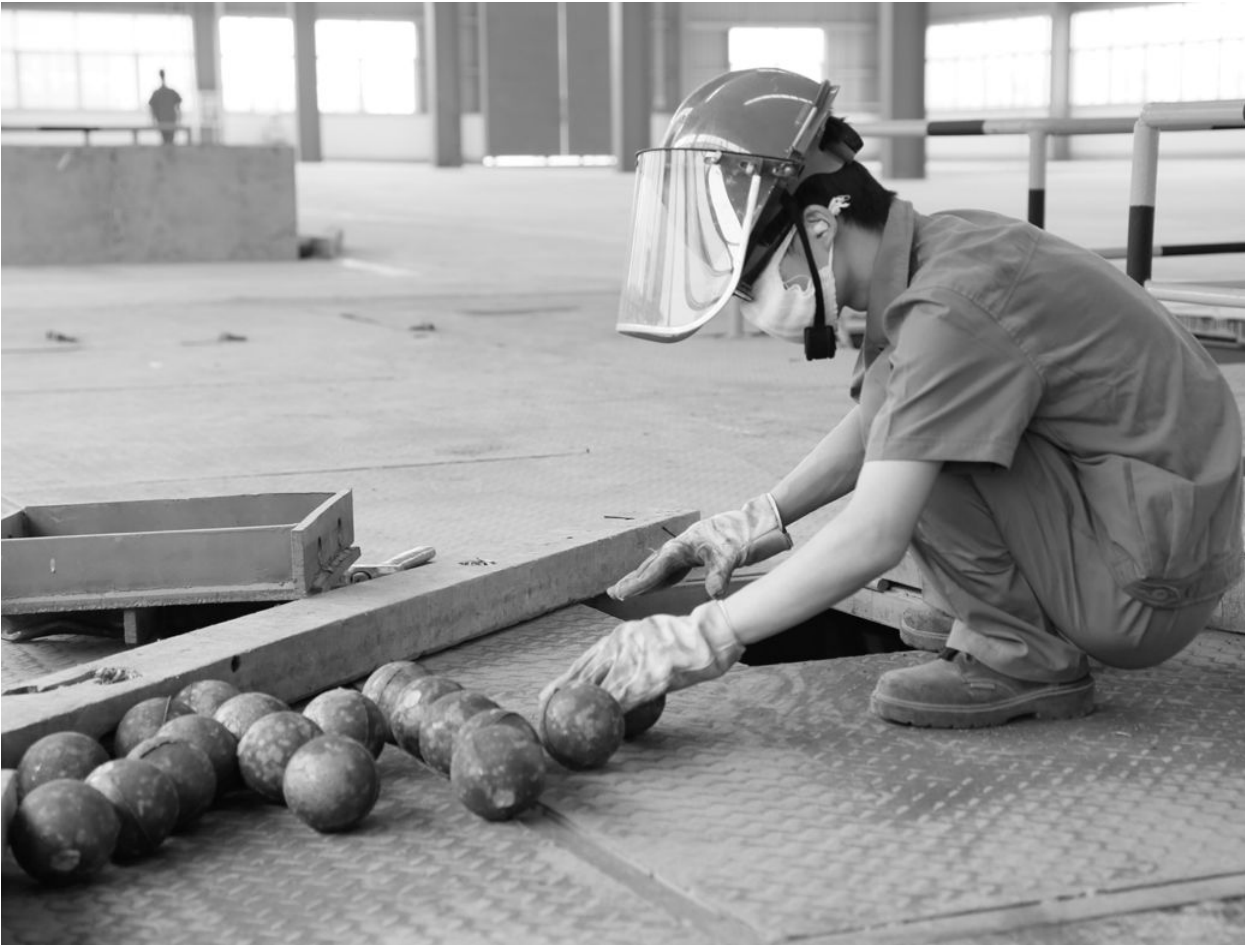
铜冠投资金神耐磨材料公司职工正在分拣铸球。铜冠投资金神耐磨材料公司始终坚持产品创新不动摇,积极与北京理工大学、合肥工业大学等高校开展合作,从材料、工艺及应用等方面大胆创新,开发新产品,为矿山企业提供质优价廉的耐磨合金钢球产品。日前,该公司生产的“半固态凝固成型铸造磨球”被安徽省经信委评定为“安徽省新产品”称号。
