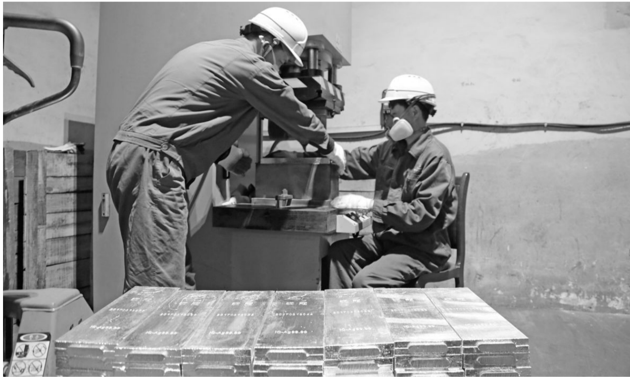
稀贵金属分公司职工日前正在对白银进行压印作业。稀贵金属分公司围绕白银工艺流程、生产操作,近年来不断健全完善质量管理体系,查找影响产品质量关键因素,完善工艺参数,改进生产人员操作要点,较好地确保了白银产品质量,银锭化学品位和物理外观均优于国家一级标准。日前,该公司生产的“铜冠牌”白银荣获了安徽名牌产品称号。 王红平 章庆 摄
