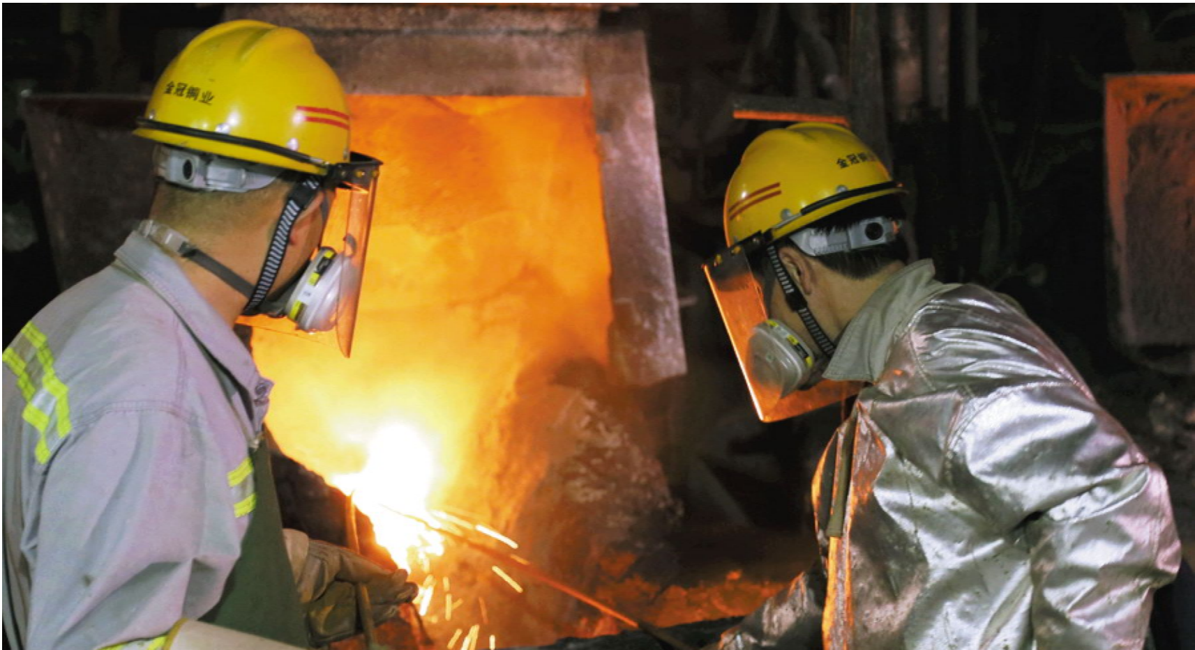
金冠铜业公司冶炼车间员工在进行吹炼炉放铜作业。
