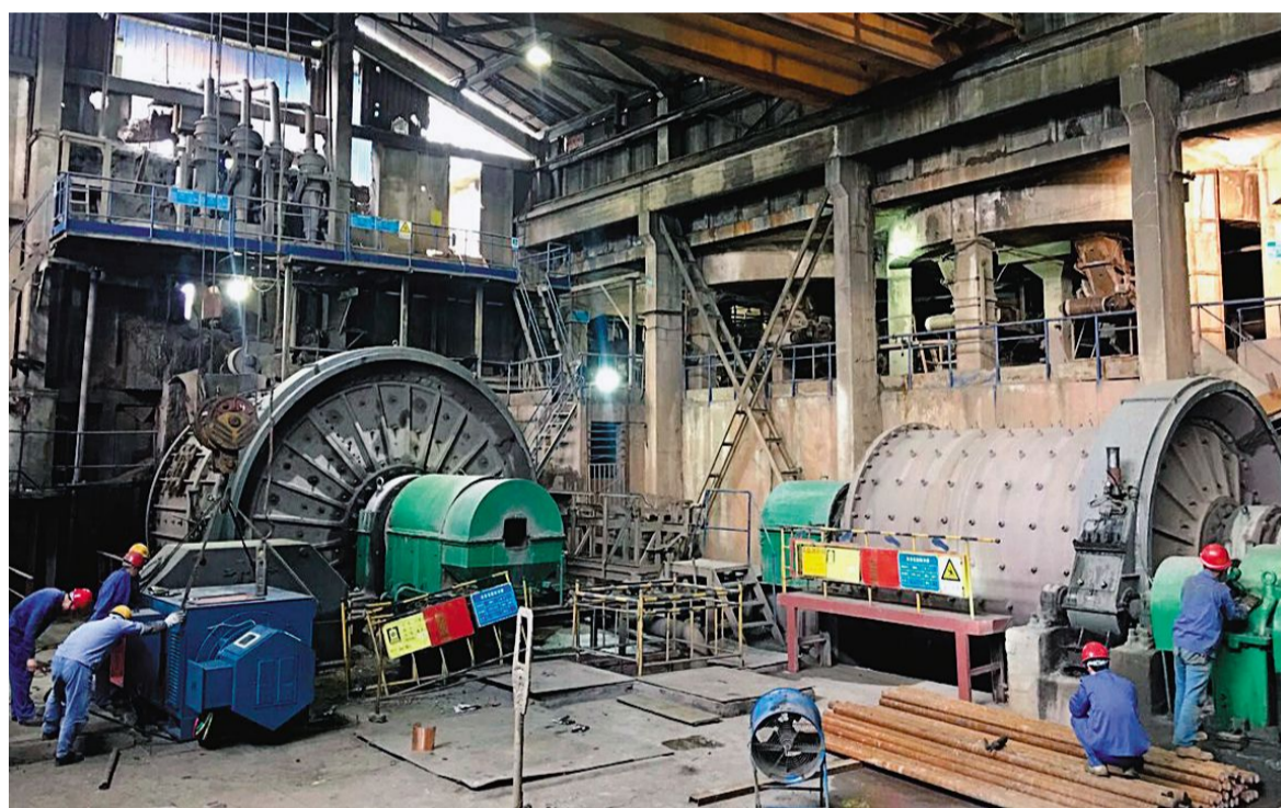
凤凰山矿业公司在生产中注重大型设备的科学使用,合理安排停车的时间,不因生产任务繁重而使大型设备带“病”工作或超期使用,有效保障了大型设备的安全高效利用率。图为“五一”小长假期间,该公司对大型磨矿设备及时安排人员维护场景。 本报记者 江君 通讯员 段青 摄
