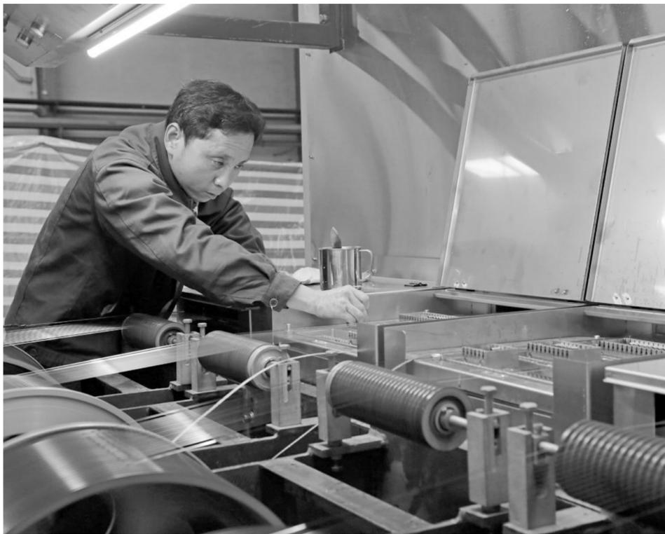
铜冠电工公司漆包线分厂职工正在对运行中漆包机进行微调。针对今年以来漆包线市场趋于好转,订单增多的现状,铜冠电工公司漆包线分厂在合理安排班次、优化生产组织的同时,积极加大运行中生产设备的维护和调整,确保了设备稳定运行,为3月份生产漆包线2082吨,创历史最高水平,提供了有力保障。
