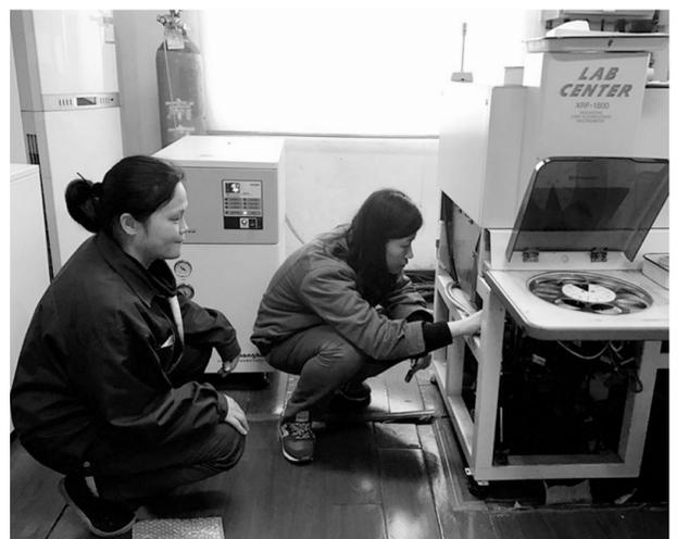
日前,技术中心检测研究中心金隆(稀贵)检测室利用稀贵分公司炉修期,组织检测人员对重要分析仪器X-荧光光谱仪进行清洁保养,为其调校转盘、更换泵油。由于该仪器使用频次高、服务年限长,不定期的自主检测将为日常检测工作的及时性、准确性提供保障。
