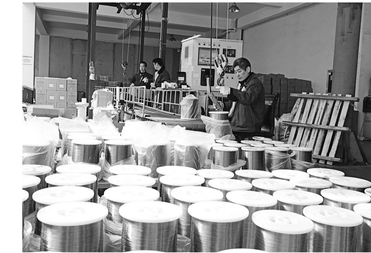
铜冠电业公司漆包线分厂职工日前正在包装作业。铜冠电业公司为优化仓储管理系统，提高仓库管理效率和管理水平，积极运用信息技术对传统的仓库管理进行改造升级，今年加快了对漆包线产品包装二维码改造进度，利用二维码将产品的入库、仓储、拣货、盘点等各个环节串联起来，实现产品的可跟踪性、可控制性和排产科学性，提高业务流程的灵活性，不断降低库存。
