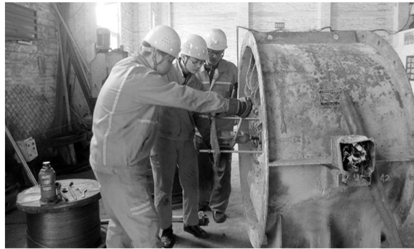
日前，冬瓜山铜矿动力车间3名钳工利用工闲时间，正在对井下运上来的废旧风帆进行拆卸，将能修复的零部件进行整合再利用。今年1至2月份，该车间仅修旧利废一项就节约材料费用10万余元。
