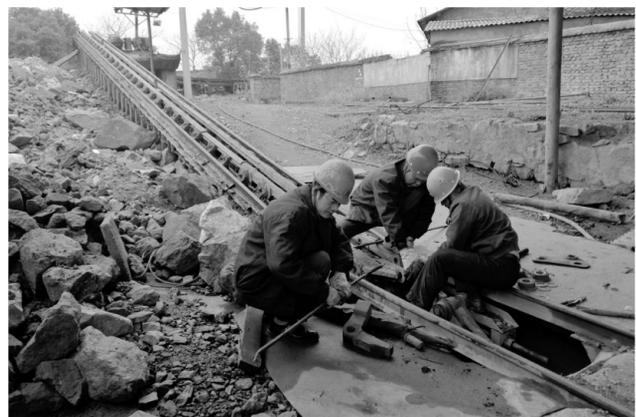
日前, 天马山矿业公司机运二区主井班职工正在更换爬车器边轮和开口销。今年以来, 该工区不断加强设备的深度保养维护工作, 对重要设备实行定人定岗负责制, 确保安全生产工作顺利进行。 夏富青 朱艳 摄
