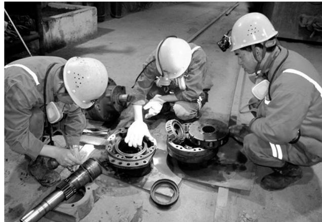
日前, 冬瓜山铜矿大团山区深孔班的 T-150 凿岩机 2 台液压马达发生故障, 经检查发现由于使用时间期限较长, 液压马达的轴承磨损几乎达到报废程度, 该区维修班人员找来以前更换下来的报废液压马达, 拆卸下轴承, 分别安装在 2 台液压马达上, 修复后投入使用, 节约材料费用近 3 万元。 徐志勇 摄
