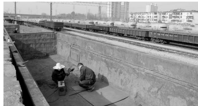
3月1日,铜冠物流金铁分公司工务段两名电焊工正在余家村工务线存放的自备车内全神贯注地焊接IC车地板(如图)。据了解,目前该分公司共有IC车34辆,专门用于冬瓜山矿到铜冠冶化的硫磺运输任务。由于在装卸过程中造成IC车车帮及底部不同程度的损坏,影响到硫磺过轨及取送作业。为了保证运输进度,金铁分公司不等不靠,在近一周时间内,对日常参与运输的IC车辆进行自检自修,目前已经维修合格的IC车达6辆,确保了硫磺按计划正常运输。邹卫东 摄
