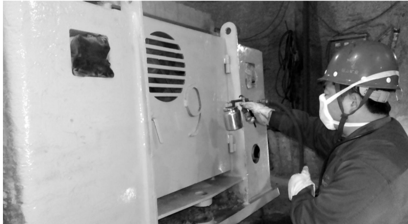
铜山矿业公司加强设备的日常维护保养，使设备的维护管理工作做到有组织、有计划、有原则、有标准、有规程地执行，以达到设备的使用寿命长、综合效能高和适应生产发展需要的目的。图为日前该公司采矿业职工正在井下负613米中段对铲运机维修保养。
