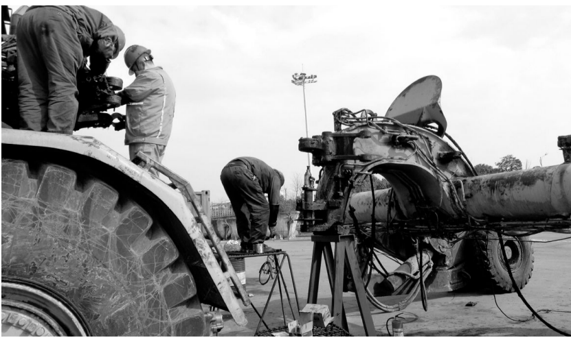
铜冠物流公司金冠车队利用主体单位大修契机，对维修时间长、工作量大、技术要求高的渣罐车维修项目进行重点安排。目前，点检班已对4号渣罐车驾驶系统和操作系统进行了分解，预计一周时间可完成对鹅颈部位的主销和衬套和平衡轴油缸这一部位的维保，并逐步更换其它三台渣罐车，力保大修期间完成4台渣罐车的维修任务。图为维修人员在对渣罐车进行维修。
