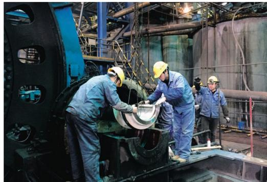
1月12日，经过两天两夜的连续奋战，铜冠建安安装公司承担的冬瓜山铜矿半自磨机及4号球磨机大修工程进入攻坚阶段。
