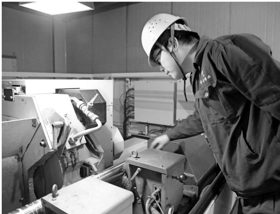
金成铜业公司职工日前正在精心磨辊作业。在铜板带生产中,表面粗糙度是一项非常重要的指标。金成铜业公司针对铜板带产品表面粗糙度平均在Ra0.10至Ra0.20左右,达不到市场高端合金类产品表面粗糙度均值Ra0.10以下要求这一瓶颈问题,该公司将降低轧辊表面粗糙度列为2016年度QC攻关课题,旨在解决高端合金用轧辊的磨削工艺,提高产品档次。该公司磨床QC小组通过QC攻关使轧辊表面粗糙度值高得到了很大的改善,粗糙度值均下降到了目标值0.1以下,从而保障了合金带材表面粗糙度值降到了0.1以下,创造了良好的直接和间接经济效益。
