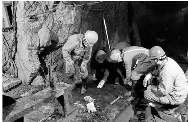
日前,凤凰山矿业公司机运车间顺利完成2米箕斗更换活动底部、三层矿曲轨侧板及更换部分衬板和本体检查加固;负312中段风水管及计量斗中段连接螺栓、混合井各中段平台罐罐器连杆、挂角螺栓、托板更换以及负396米大皮带更换加固等工作。通过此次检修,为2017年安全生产奠定了良好的基础。
