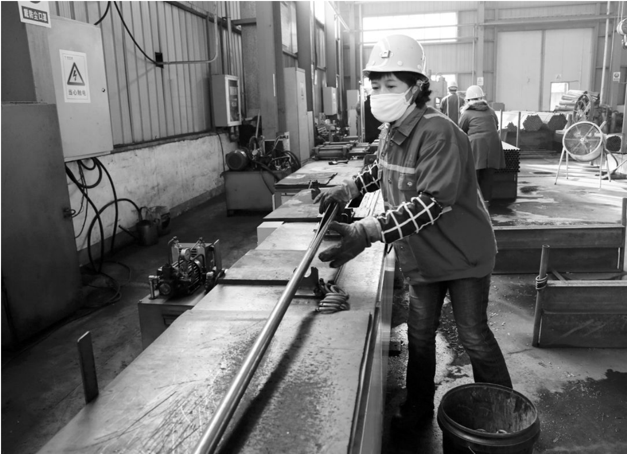
铜冠矿建公司机械修造公司职工目前正在加工管缝式锚杆(如图)。铜冠矿建公司面对矿山施工中锚杆需求增加，传统生产制作难以满足需求的现状，积极开展了《管缝锚杆生产工艺技术研究》，成功开发出新产品管缝式锚杆。新上的管缝式锚杆自动化生产线自去年在所属机械修造公司投产以来，目前已实现了批量生产，年产锚杆可达4万根。王红平 陶莉 摄
