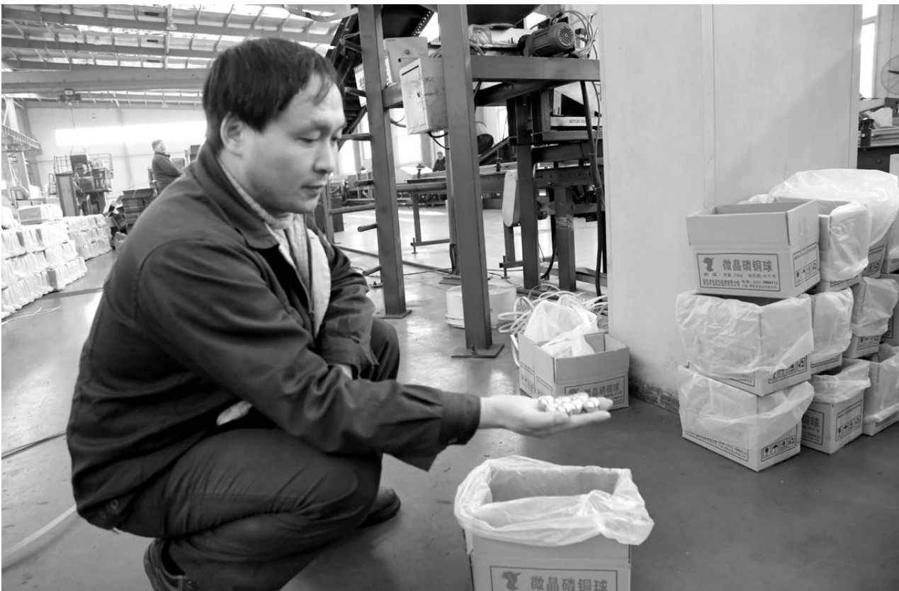
11月30日,铜冠电工公司磷铜分厂职工在查看微晶磷铜球。铜冠电工公司磷铜分厂根据高端市场要求,今年利用闲置的连续挤压机组,在传统磷铜生产线中新增连续挤压工序,成功地完成了微晶球研制开发工作,使得磷铜品质显著提升。目前,该项新产品已实现批量生产和销售。
