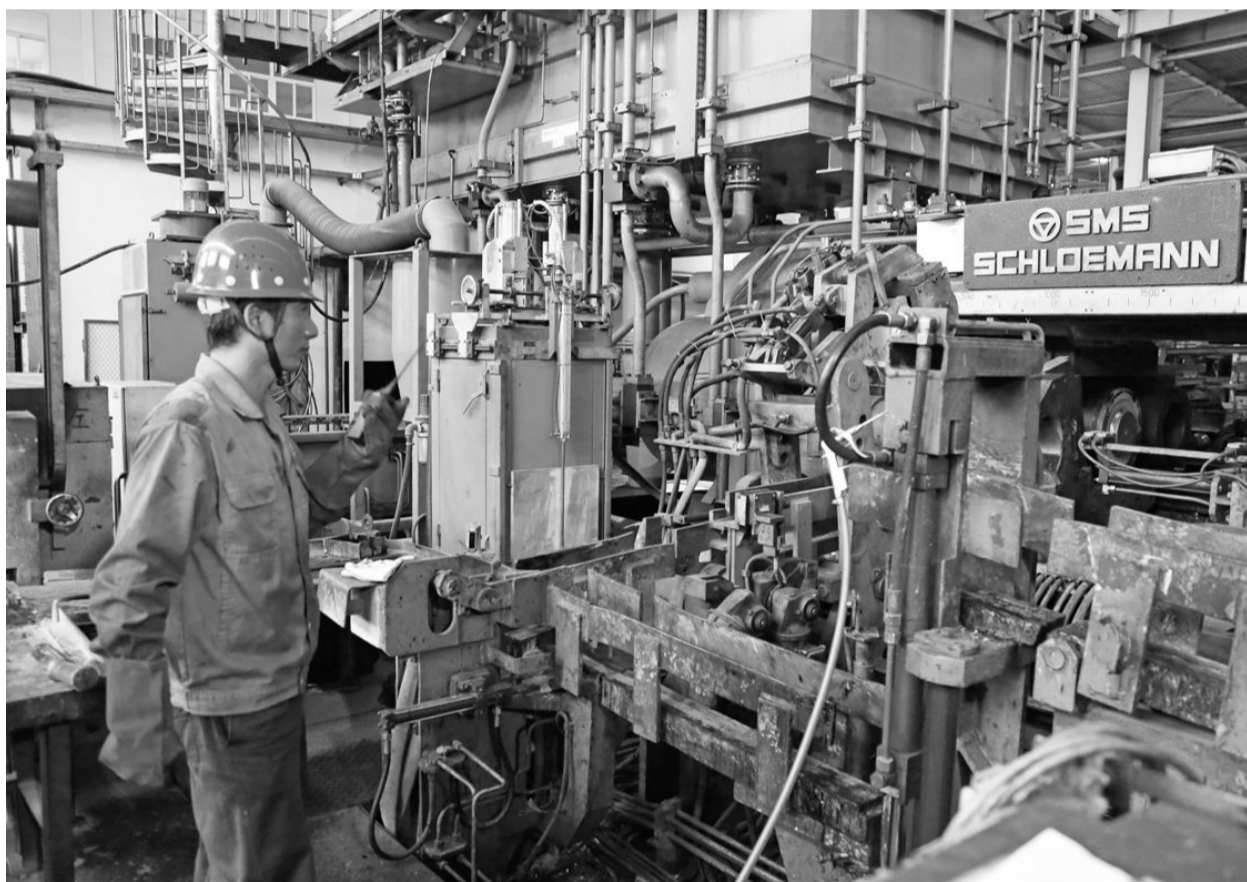
铜冠黄铜公司专业维修人员日前正在检修中调试进口设备挤压机。铜冠黄铜公司以稳定设备运行为主线,今年通过持续推进备件国产化,提高了设备保障能力。其中,针对挤压机横移频繁出现撞缸现象,通过查阅图纸、与供应商联系,对原有进口液压缸缸体进行改制,国产化效果明显,目前运行良好,不仅降低了维修费用,还提高了进口设备的运行质量。
