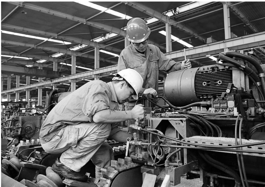
铜冠黄铜公司日前职工正在保养联合拉拔机。铜冠黄铜公司今年采取除熔铸车间必须采取连续铸造方式外,挤压、拉拔等其它生产线根据订单情况开始调整为“间歇式”生产。在每次停车间歇期间,该公司积极组织设备大修和日常维护保养,确保了设备的正常运转,提高了设备生产效率。 王红平 汪勇 摄
