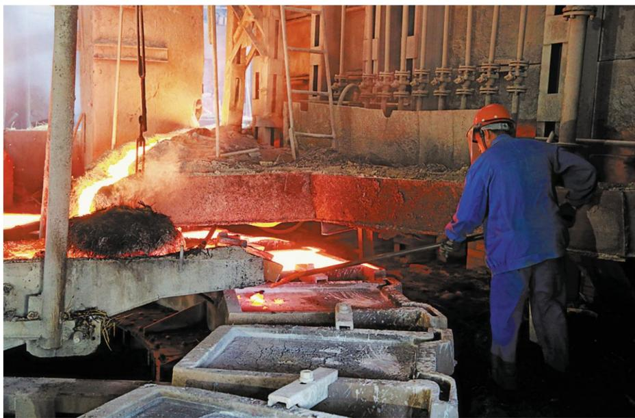
金昌冶炼厂职工日前正在阳极板浇铸中作业。金昌冶炼厂面对严峻的环保形势以及工艺设备陈旧老化等困难,今年以来通过提前谋划,以“环保优先”为原则,强化工序服从理念,“以硫定产”,狠抓铜酸系统平衡,及时恢复一期制氧供氧,并针对电解停产无酸返转炉实际,加大冷铜处理量,1至8月份完成粗铜产量7.92万吨、阳极铜产量9.92万吨,较好地保持了生产稳定。 王红平 齐宏明 摄
