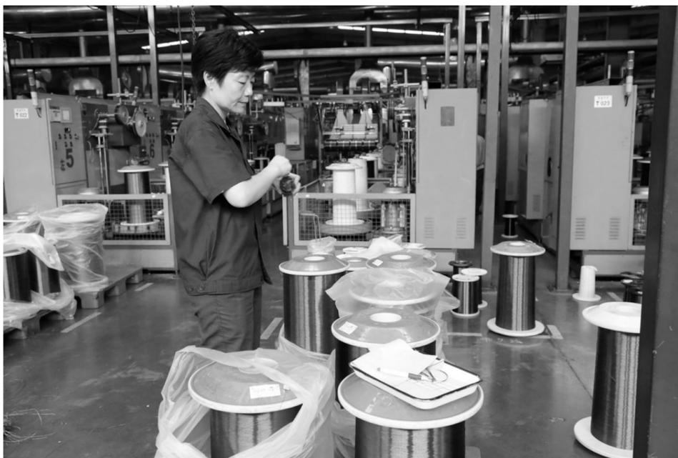
铜冠电工公司质检员日前正在漆包线生产现场取样。为提高漆包线产品的市场竞争力,铜冠电工公司今年着力在产品研发创新的同时,在产品品质管理上狠下功夫,严格落实公司工艺纪律检查制度,加强漆包线生产过程检验和最终检验,确保客户技术要求得到有效贯彻落实,取得了成效,使得本部漆包线成品率高达97.84%,芜湖漆包线成品率达97.93%。
