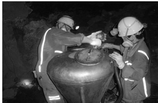
8月23日上午,冬瓜山铜矿井下负800米42线6号采场,两名爆破工正在仔细检查装药器的压力表(如图),保证当天4.08吨炸药安全输送到采场顶板上的钻孔内。截至8月22日,今年该矿采矿区已完成孔径76毫米中孔采矿90万吨,粒状装药使用量突破400吨,平均每名专职操作装药器的爆破工,都经受了一百吨以上炸药的输送考验。
