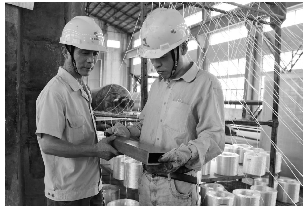
铜冠投资金泰玻璃公司职工日前正在查看新产品玻璃钢线条。金泰玻璃公司为提高产品市场竞争力,增加产品销量,积极研发新产品,并取得了成效,成功地研制出玻璃钢线条,用以替代冶炼、化工等行业屋面钢结构线条。新产品不仅克服了传统钢结构线条易腐蚀的弊端,还延长了使用寿命,降低了维护费用和检修安全风险。目前,该公司这一新产品正在申报国家专利。王红平 王强 摄
