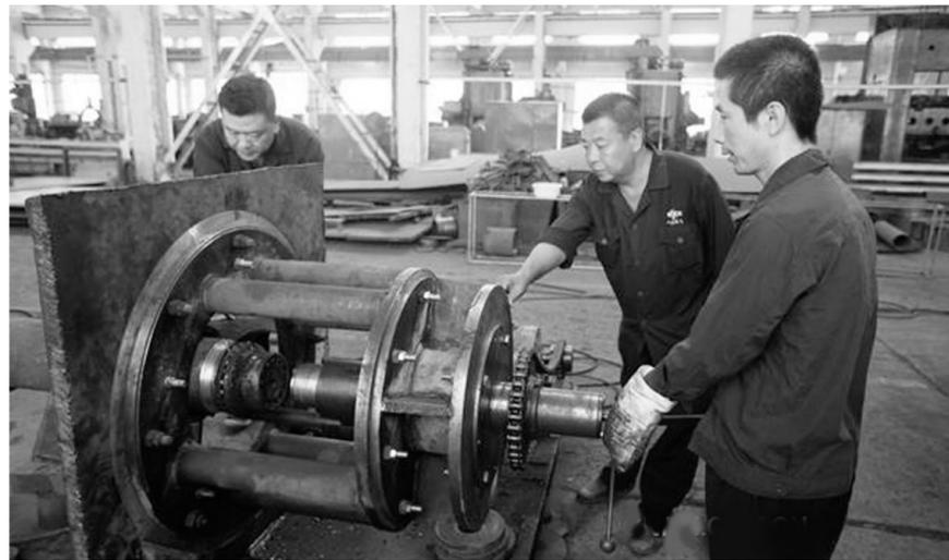
组迅速赶赴现场,奋力抢修,在高温、震动等各种不利因素制约的情况下,面对急需修复又无法移动的280毫米直径的巨大主轴,他们将自制机床固定在设备上,有序使用电动机、减速机、刀具等相关配套设备,在长达4个
