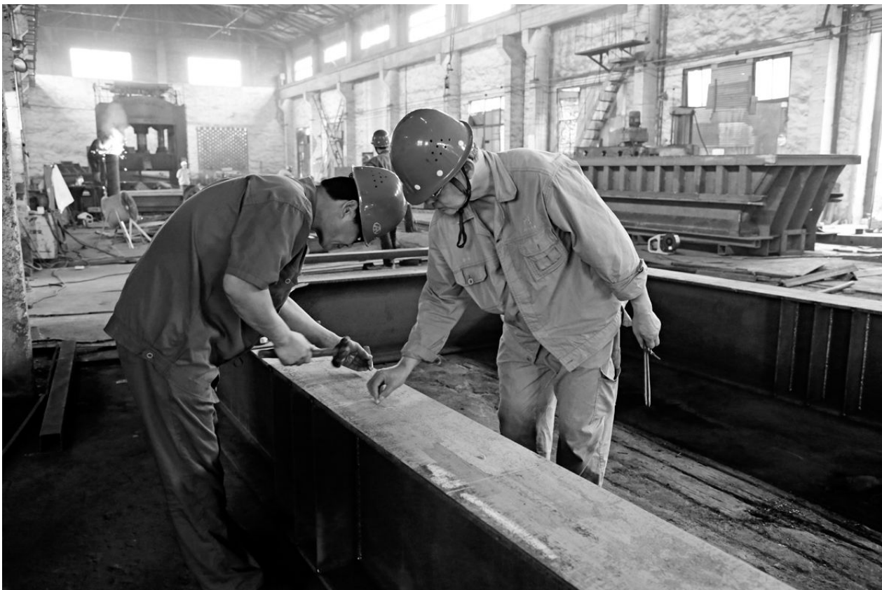
铜冠机械公司矿冶设备制造分厂职工目前正在加工浮选机横梁。矿冶设备制造分厂今年承接了出口厄瓜多尔米拉多浮选机，浮选机体积达320立方米，加工量大，制作要求严。为满足客户需求，该分厂组织精干力量，对照标准，精心施工，较好地保证了加工进度。
