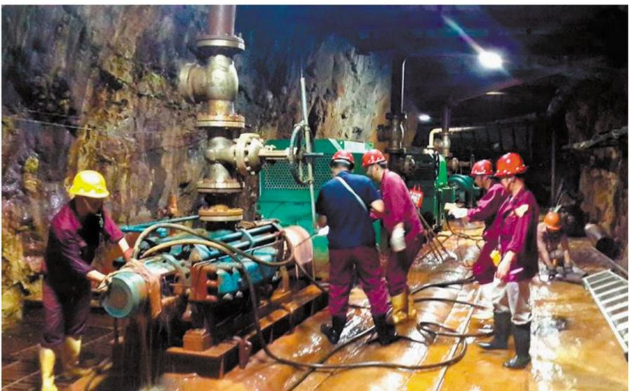
连日来持续强降雨,给天马山矿业公司井下防洪工作带来严峻考验。井下各个中段涌水严重,自6月29日开始负255中段五台水泵连续工作五天进行排水,不间断的运转导致水泵轴承破碎,7月5日上午,维修人员对水泵进行及时抢修,确保井下安全生产和职工生命财产安全。
