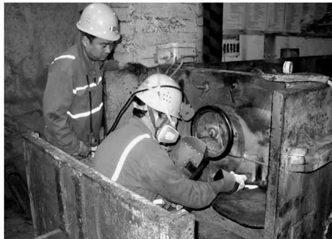
大团山工区580米中段的11号电机车头,由于长期超负荷工作,设备有些内部部件磨损严重。该区维修人员仔细检查后,制定大修方案,经过15天的拆卸、安装,修复好的电机车头又投入到生产一线使用。
