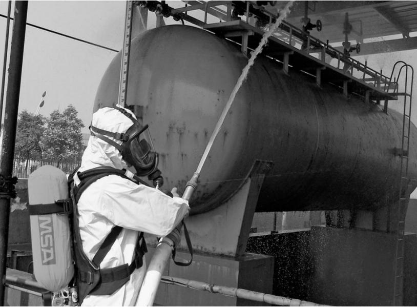
金冠铜业公司职工日前正在液氨储存区液氨泄漏应急预案演练中喷水。金冠铜业公司针对保护性气体站液氨储存区这个危险源点,日前组织开展了液氨储存区液氨泄漏应急演练。通过演练评估公司应急准备状态和应急能力,发现并及时修改应急预案、执行程序、行动中的缺陷和不足,避免以后发生类似事故,进一步提高相关人员的业务素质和能力。
