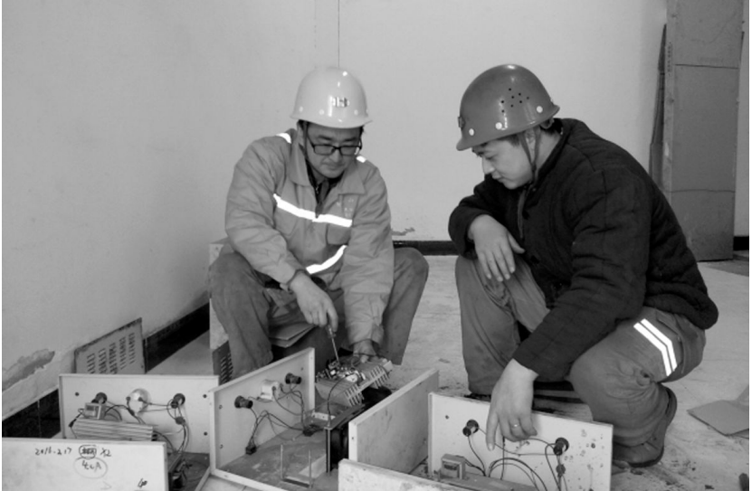
冬瓜山铜矿精矿车间认真落实降本增效工作,针对陶瓷过滤器超声波电源发生器消耗量大,备件费用较高的实际,组织电气技术和维修人员自己动手,配备专用工具,购买电气元件,对更换下来的超声波电源故障进行检查诊断,维修调试(如图),已成功修复 6 台用于生产,效果良好,仅此一项可为矿山节约备件费近 2 万余元。 郑子龙 摄
