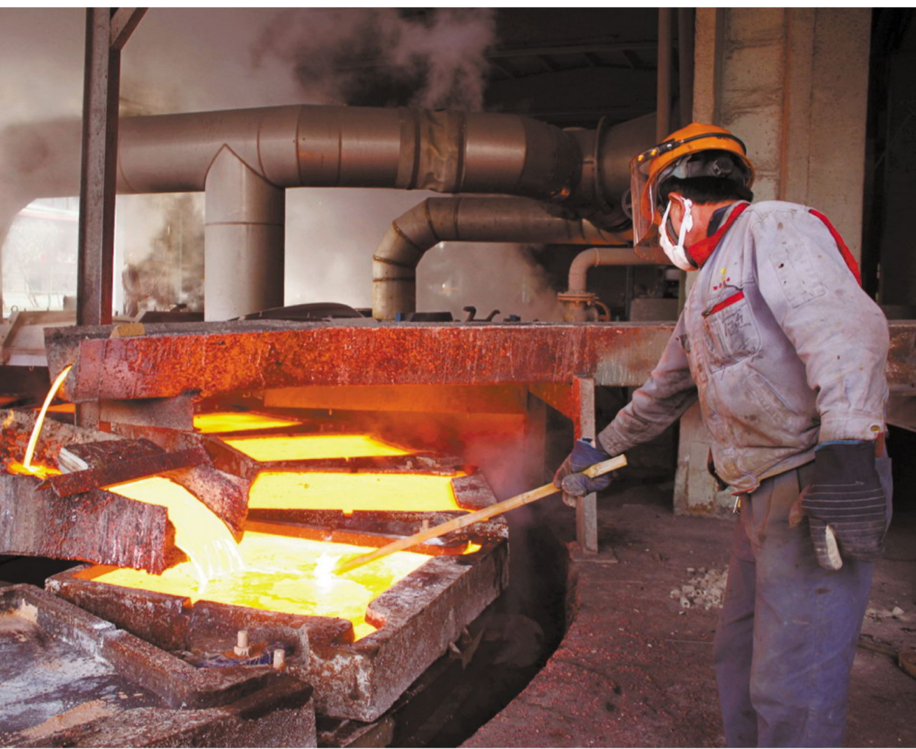
2月18日,张家港联合铜业公司精炼车间2号阳极炉正在出铜。春节刚过,该公司迅速掀起大干热潮,改造升级后的三台阳极炉全部投入满负荷生产,日产量达到650吨,单炉产量较改造前提高一倍以上,主要经济技术指标处于同行业领先水平。杨学文 摄
