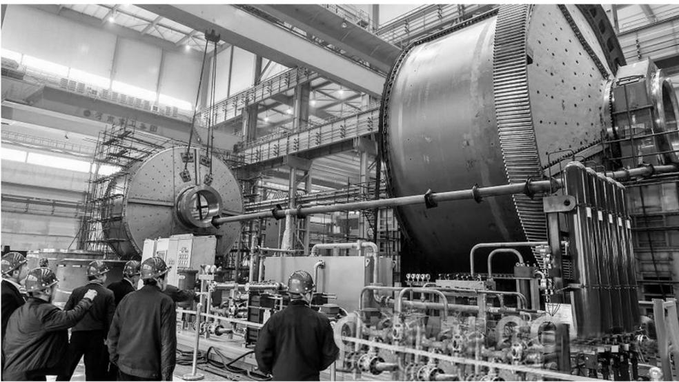
近日,中信重工为“中国第一大金矿”——紫金矿业紫金山金铜矿新建项目研制的核心装备 Φ7.9×13.6m 溢流型球磨机、Φ11×5.4m 半自磨机一次试车成功交付用户,投用后将使紫金山金铜矿日增加产能 4 万吨。
