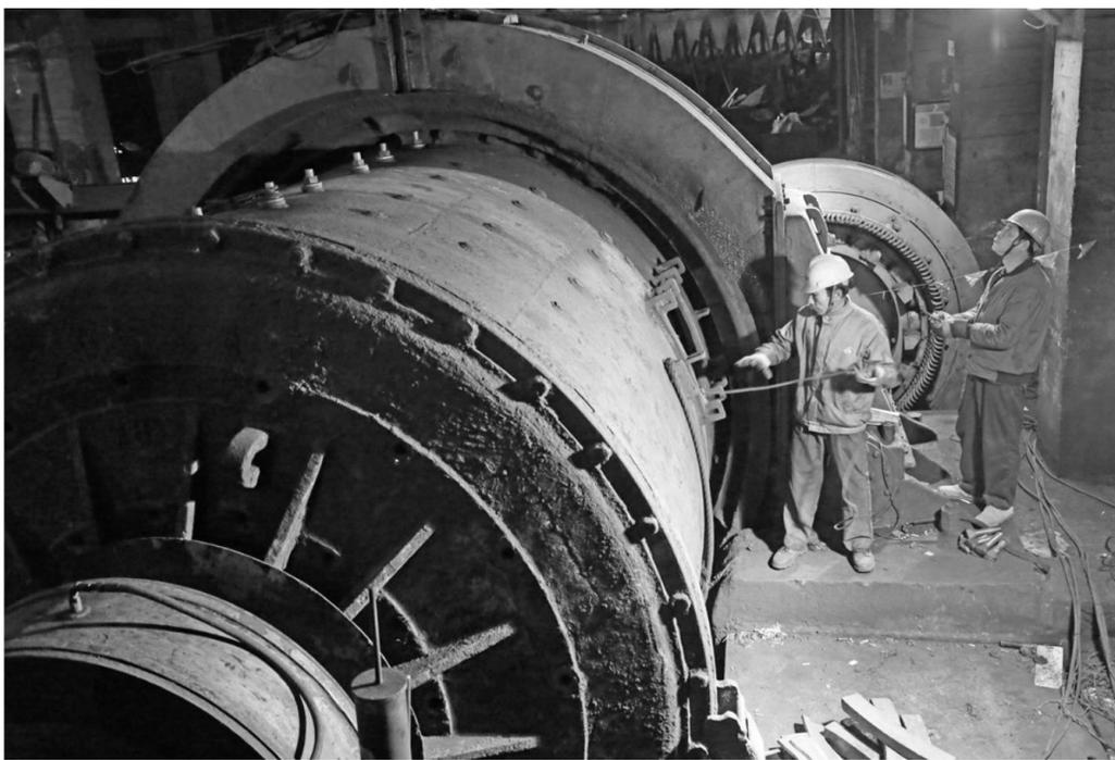
天马山矿业公司选矿车间职工日前正在更换球磨机衬板。天马山矿业公司选矿车间球磨机内部衬板过去一直采用锰钢板,由于使用寿命短,导致更换和维修费用大。选矿车间通过采纳职工合理化建议,用复合板替代锰钢板,使得球磨机衬板使用寿命从过去的6个月延长到20个月,不仅减少了更换次数,也大大节约了衬板更换费用,每年因此可节约综合成本约80万元。
