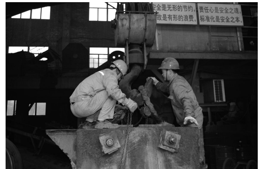
天山矿业公司金岭选矿车间从12月20日至24日进行年终检修工作。此次检修工作在保证安全、高质、高效、节能的前提下,对全厂设备进行一次全面的大检修,确保安全生产稳步推行。图为该车间职工正在清理检查颚式破碎机箱体。
