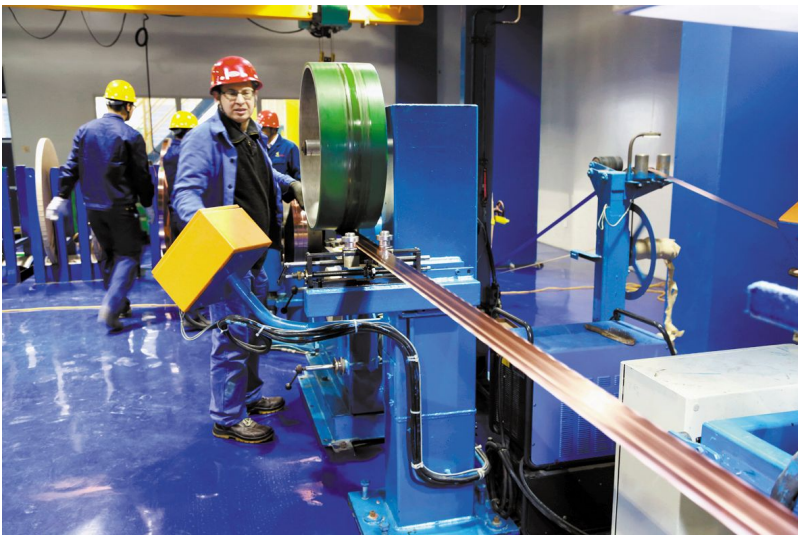
图为该公司第一条生产线正在轧制高端异性电子铜带。
