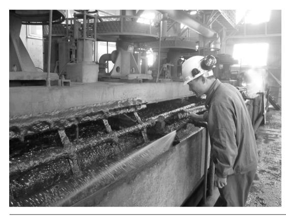
今年以来,稀 贵金属分公司渣选 矿车间充分发挥自 主创新能力,科学 组织生产, 加强工 序间协调配合,不 断完善工艺设备, 各项经济技术指标 稳步提升,圆满完 成各项工作任务。 图为磨浮工段技师 徐国胜正在调节精 选浮选机。
