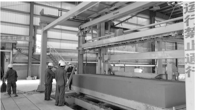
近日,铜冠建安新型环保建材公司多次召集加气块生产线及设备厂家技术人员共同研讨生产工艺和设施改造这一技术课题,通过技术攻关,成功实现工艺进一步改进,设施进一步完善,消除了制约产能的技术瓶颈,降低了生产成本,实现了产能质量双提升。目前,单班产能达256立方米,这是该公司加气块生产线自试生产以来单班的最高产量,该公司将力争单班产能突破320立方米。
