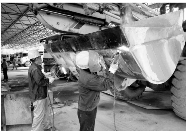
今年以来，铜冠商品混凝土公司持续开展“对标挖潜、提质增效”活动。11月6日，该公司组织维修人员将装载机铲斗自行更换焊接，仅此一项就节约费用近万元。图为该公司维修人员正在焊接相关设备。
