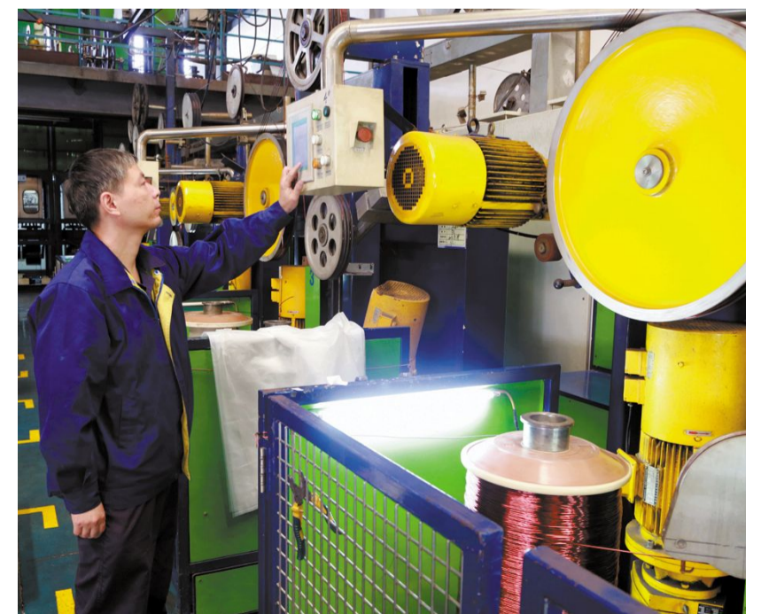
铜冠电工厂漆包线分厂职工日前正在立式漆包机监控生产参数。铜冠电工厂在提升漆包线质量上，坚持持续改进工艺，其中，针对立式漆包机通过加强在线检测手段的控制，着重解决了立机大规模漆包线成串粒子问题，完善了所有高速漆包机粒子控制的技术问题，避免了粒子质量问题的重复发生，促进了漆包线品质进一步改善。王红平 芦广胜 摄
