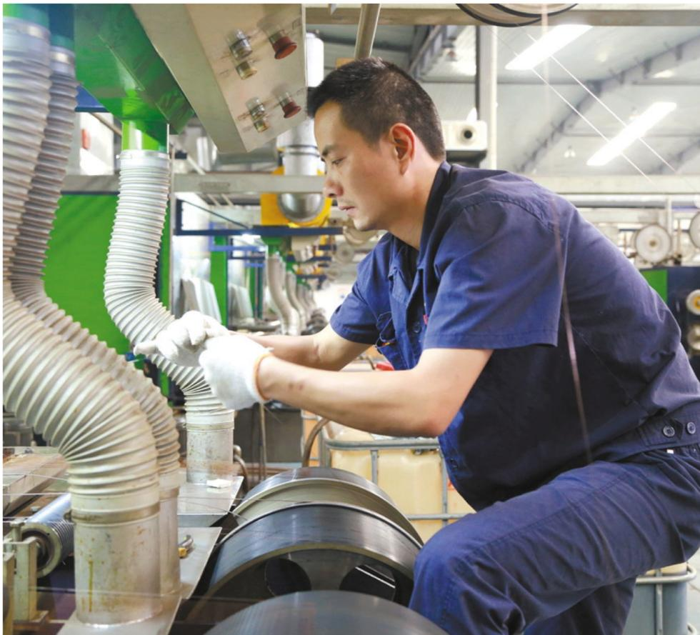
铜冠电冶公司职工日前作业中对模具调整。铜冠电冶公司漆包线分厂以提高设备的完好率和设备的运行效率为抓手，深化设备TPM管理，加强对生产设备和特种设备的维护和保养，并以日常点检和预防性维修相结合，使今年以来生产设备完好率达到98%以上，从而为实现设备运行“零故障”，保障生产稳定，创造了积极条件。
