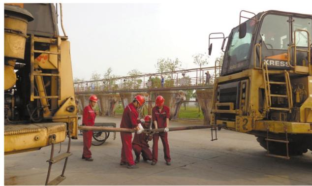
10月26日，铜冠物流公司金冠车队利用主体大修间隙，组织渣罐车全体员工开展了炉口拖车应急演练（如图）。演练以作业小组为单元，从渣罐车出现故障，到点检维修人员利用专业工具解除车辆刹车和锁钩并排除故障，参加应急演练的职工相互间配合默契，落实到人，达到了预期效果。
