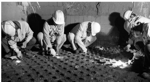
日前,铜冠冶化分公司硫酸一期系统焙烧炉在烘炉之前,需要疏通约9000个风帽眼,任务比较艰巨。硫酸车间党支部积极组织党员和生产骨干等50多人,在焙烧炉内打着手电筒,用钢钎、电钻等工具进行不间断轮流疏通。经过4个多小时的奋战,终于将9000个风帽眼疏通完成。 朱长华 摄
