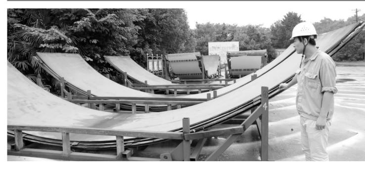
铜冠机械公司矿冶 设备制造分厂职工日前 正在检查槽罐体防腐情 况。矿冶设备制造分厂 于8月份承接了一个出 口哈萨克斯坦项目,即 制作5个槽罐,不仅制 作精度和防腐质量要求 高,同时制作难度系数 大,其中一个最大的槽 罐直径 11.47 米,高 4.08 米。由于体积大,只 能分体制作,现场组装。 目前,制作工作已顺利 完工,进入了发货程序。 王红平 王征社 摄
