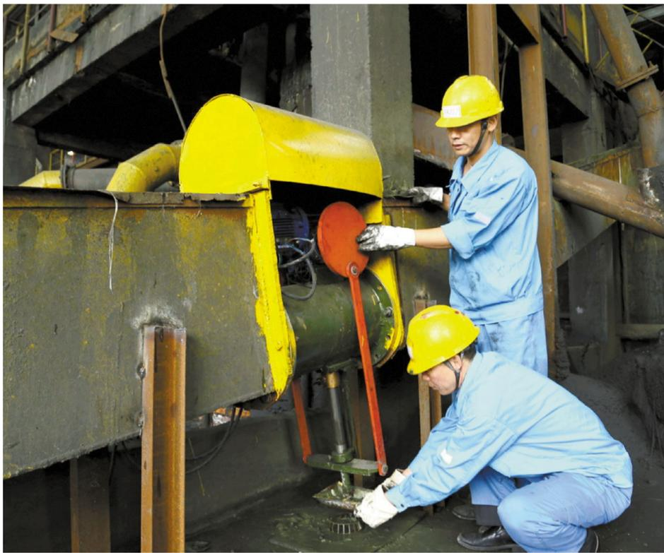
10月13日，安庆铜矿选矿车间技术员和取样工正在对铁精矿进行取样。据了解，最近安庆铜矿对选矿和重介质系统的钢铁原矿溜槽、过滤系统及钢铁精矿溜槽等处安装了10台自动取样机，既大大减轻了劳动强度，又提高了取样的精准性，并改善了作业现场环境，可谓一举三得。
